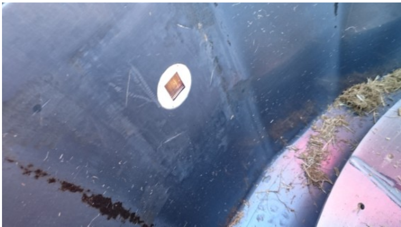
Foto 1. NIR "øjet" placeret i forenden af blandekarret. Instrumentet er placeret på første plade til højre for midterlinjen og med "øjet" 50 cm over blandekarrets bund.
